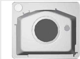
Le filtre antigrasse situé sur la paroi arrière du four protège le ventilateur, les résistances et les parois du four des éclaboussures de graisse. Insérez toujours le filtre pendant la cuisson de la viande, mais enlevez-le pour cuire les pâtisseries. L'utilisation du filtre pendant la cuisson des gâteaux peut entraîner de mauvais résultats.
