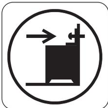
1. Installez la protection anti-bascule 232 - 237 mm en-dessous de la surface supérieure de l'appareil et à 110 - 115 mm à côté de l'appareil, dans l'orifice circulaire situé sur un support. Vissez-la dans un matériau solide ou utilisez un renfort adapté (mur).
