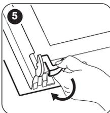
**5** Désengagez le système de verrouillage pour retirer les panneaux de verre intérieurs.
