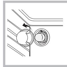
2. Dévissez l'ampoule et remplacez-la par une autre de même type : tension 230 V, puissance 25 W, culot E 14.
