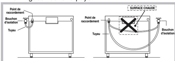
! Si une ou plusieurs de ces conditions ne peuvent être remplies ou que la cuisinière est installée dans des conditions de classe 2 – sous-classe 1 (appareil encastré entre deux meubles), il faut utiliser un tuyau flexible en acier (voir ci-dessous).
