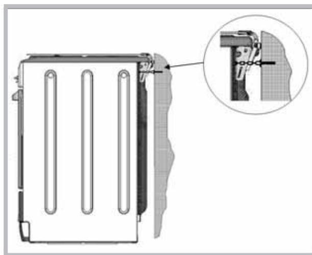
! Pour éviter le basculement de l'appareil, par exemple si un enfant s'accroche à la porte du four, la chaîne de sécurité DOIT être installée !
