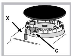
Si l'appareil est équipé d'un allumage électronique\* (C) (voir figure) il suffit de pousser et de tourner en même temps dans le sens inverse des aiguilles d'une montre le bouton BRULEUR sur le
