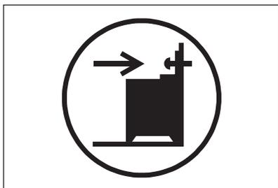
1. Installez la protection anti-bascule à une distance de 317 mm à 322 mm en-dessous de la surface supérieure de l'appareil et à une distance de 80 mm à 85 mm du côté de l'appareil, dans l'orifice circulaire situé sur un support. Vissez-la dans un matériau solide ou utilisez un renfort adapté (mur).
