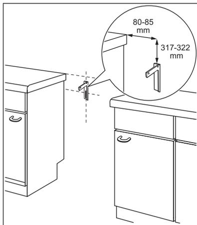
2. L'orifice se trouve sur le côté gauche, à l'arrière de l'appareil. Soulevez l'avant de l'appareil et placez-le au milieu de l'espace entre les placards. Si l'espace entre les placards est supérieur à la largeur de l'appareil, vous devez ajuster la mesure latérale si vous souhaitez centrer l'appareil.
