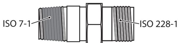
Vissez l'extrémité fileté du tuyau flexible dans l'admission de gaz. Lorsque le raccordement est terminé, effectuez un essai de pression pour contrôler l'étanchéité de la cuisinière.
