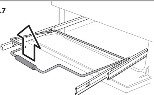
Procédez comme suit pour retirer la lèchefrite à des fins de nettoyage. Pour retirer le support de la lèchefrite, tirez la lèchefrite vers l'avant (**Fig.6.5**). Soulevez la lèchefrite du support. Le support est maintenu sur les glissières latérales par deux clips de chaque côté (**Fig.6.6**). Pour chaque côté, soutenez la glissière latérale d'une main et, de l'autre, soulevez le support pour le dégager des clips latéraux (**Fig.6.7**).
