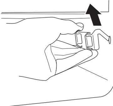
Pour faciliter le nettoyage de l'enceinte du gril, vous pouvez retirer les glissières latérales en les décrochant des côtés de l'enceinte (**Fig.6.8**) et essuyer les côtés avec un chiffon doux imbibé de détergent doux.
