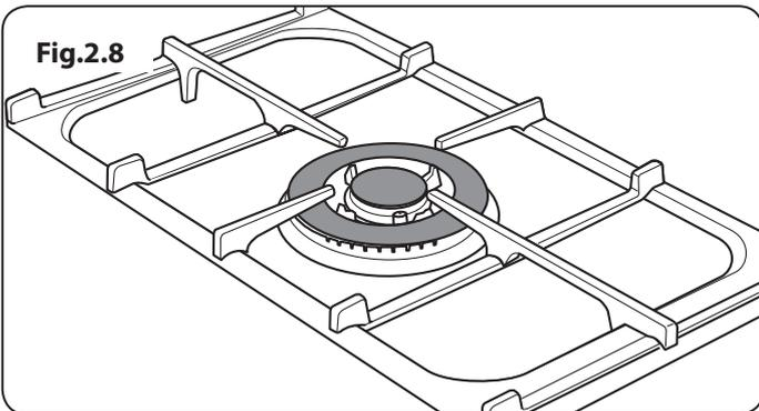
Le dispositif d'allumage produit une étincelle et allume le gaz. Continuez d'appuyer sur le bouton pendant quelques secondes pour permettre l'arrivée du gaz dans le brûleur (10 secondes).
