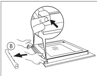
1. Saisissez les deux côtés du cache (B) situé sur l'arête supérieure de la porte et poussez-le vers l'intérieur pour permettre le déverrouillage du système de fermeture.
