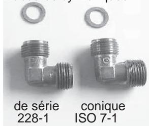
Attention : selon la réglementation en vigueur dans certains pays (voir tableau gaz page 6), il est obligatoire de procéder au remplacement du raccord cylindrique monté en série sur la cuisinière et de le remplacer par un raccord conique\* fourni avec l'appareil.
