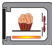
**Sole brassée** : utilisation de la résistance de sole et de la turbine qui brasse l'air dans l'enceinte du four. Cette fonction est idéale pour les tartes à fruits juteux, les tourtes, les pâtés ... Elle évite le dessèchement des aliments et favorise la levée pour les cuissons de cakes, pâte à pain et autres. Cuisson par le dessous. Placer la grille à un niveau inférieur. Préchauffage en Chaleur brassée pendant 7 minutes.
