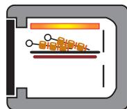
**Gril** : utilisation de la résistance de voûte, résistance supérieure. C'est le succès assuré pour les grillades, les brochettes et les gratins. Un préchauffage de 5 minutes est nécessaire pour le rougissement de la résistance. L'utilisation du grilloir doit être réalisée porte fermée. Le four droit propose deux positions gril : gril = 2140 W, gril avec complément = 3000 W.
