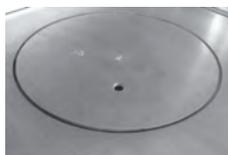
**PLAQUE COUP DE FEU :** idéale pour la réalisation de cuissons simultanées, de sauces, de mijotages prolongés, ou de maintien au chaud. Selon la préparation, il est possible d'ajuster le réglage soit en agissant sur la manette soit en déplaçant le récipient sur la plaque en fonte. La température centre plaque atteint 400°C, vers l'extérieur la température décroît jusqu'à 100°C permettant les mijotages les plus doux, comme à l'ancienne.
