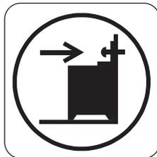
1. Installez la protection anti-bascule 317 - 322 mm en-dessous de la surface supérieure de l'appareil et à 80 - 85 mm à côté de l'appareil, dans l'orifice circulaire situé sur un support. Vissez-la dans un matériau solide ou utilisez un renfort adapté (mur).
